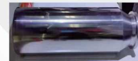
石油柱塞 产品要求:耐磨耐蚀 熔覆厚度:单边0.45mm 熔覆效率:0.60m 2 /h 熔覆层硬度:>62HRC 产品性能:使用寿命提高3倍
