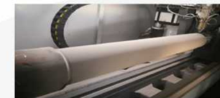
煤矿液压支架立柱 产品要求:耐蚀 熔覆厚度:单边0.6mm 熔覆效率:0.45m 2 /h 熔覆层硬度:>55HRC 产品性能:中性盐雾试验2000h以上
