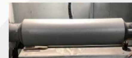
轧辊 产品要求:耐磨 熔覆厚度:单边0.5mm 熔覆效率:0.50m 2 /h 熔覆层硬度:>62HRC 产品性能:使用寿命提高2倍
