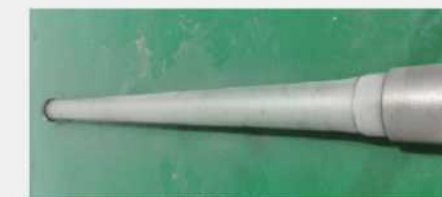
石油钻杆 产品要求:耐冲蚀 熔覆厚度:单边0.55mm 熔覆效率:0.50m 2 /h 熔覆层硬度:>62HRC 产品性能:下井服役寿命提高3倍
